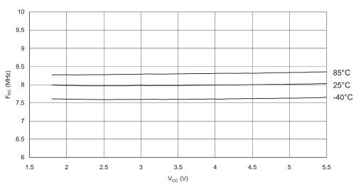
CALIBRATED 8MHz RC OSCILLATOR FREQUENCY vs.  $\rm V_{\rm CC}$
