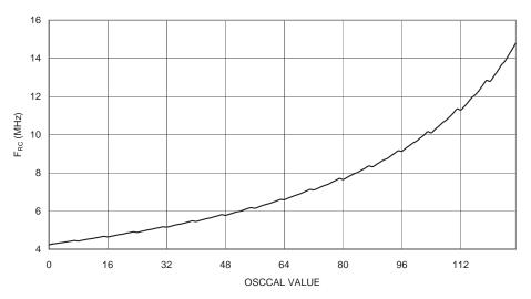
CALIBRATED 8MHz RC OSCILLATOR FREQUENCY vs. OSCCAL VALUE
